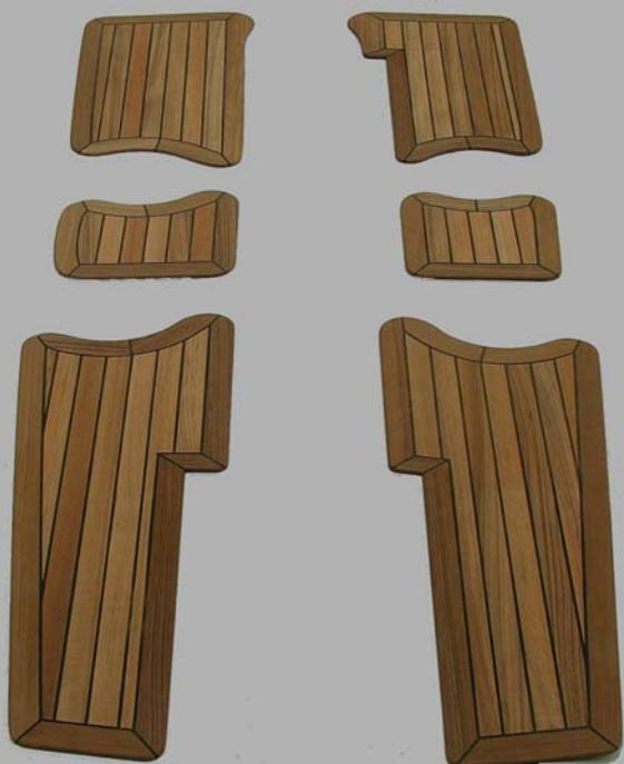
**Teak Stabdeckleisten 34x 4,8mm, 8mm oder 12mm, auf einer 1,5mm starken HPL-Kunststoff-trägerplatte. Abstände der Fugen 34:4:34mm. Vergossen mit Sikaflex 290DC. Leibholz ca. 45mm breit.**
